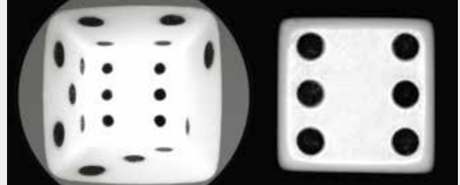
ハイパーセントリックレンズによるサイコロの画像 (左) と固定焦点レンズによる画像 (右)
