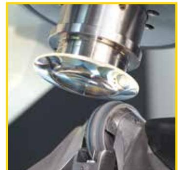
MRF (粘弾性磁性流体研磨仕上げ)
